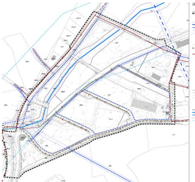
Skica 7.7.: Trasa kanalizacijske mreže unutar UPU Montepozzo-Laconovo
